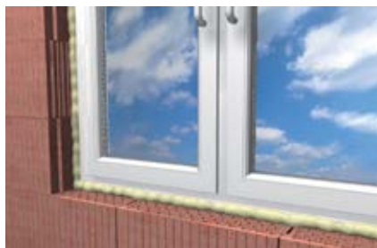
Швы оконных соединений
